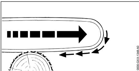
Wenn mit der Unterseite der Führungsschiene gearbeitet wird, wird der Hoch-Entaster weg vom Benutzer gezogen.
