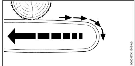
Wenn mit der Oberseite der Führungsschiene gearbeitet wird, wird der Hoch-Entaster in Richtung des Benutzers gestoßen.
